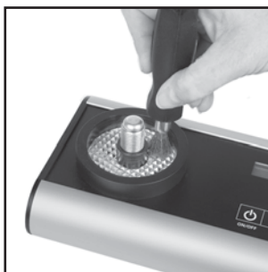
Figura 7. Limpieza de la celda.
