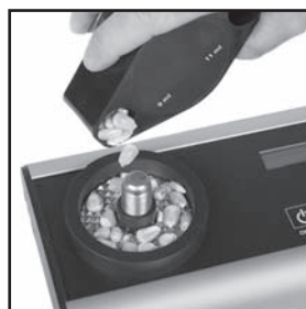
Figura 3. Vierta el grano en la celda.
